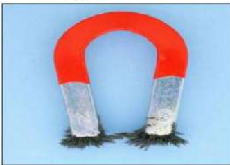
الشكل (9-ج) تجمع برادة الحديد بتركيز عالي عند القطبين المغناطيسيين لقطبين متشابهين يشكل حرف U.
