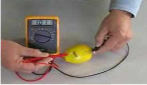
مقياس للتيار الكهربائي (ملي أميتر)، مسمار مغلون، قطعة من النحاس، حبة ليثيوم حامض، أسلاك توصيل.
