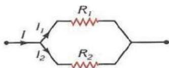
حيث ان المقاومتان (  $R_1, R_2$  ) مربوطة على التوازي بحيث تتوفر عدة طرق للتيار الكهربائي
