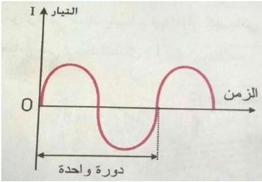
عند دوران الملف داخل المجال المغناطيسي المنتظم قاطعا خطوط المجال المغناطيسي (سيحصل تغير في خطوط المجال المغناطيسي) وبالتالي ستولد قوة دافعه كهربائية محتثة (emf) محتثة في الملف وبالتالي ينساب التيار الكهربائي المحتث في ملف النواة عبر الحلقتين المعدنيتين والفرشتين الى الدائرة الخارجية .
