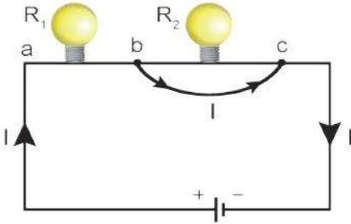
ج/ لان السلك المربوط الى طرفي المصباح ولد دائرة قصيرة ينساب فيها معظم التيار فتقل المقاومة الكهربائية المكافئة وبالتالي يزداد مقدار التيار المنساب في المصباح الثاني فيزداد توهجه
