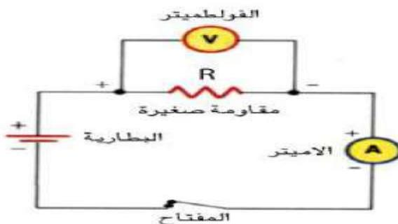
مخطط للدائرة الكهربائية
