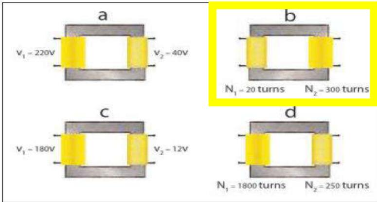
6- الشكل التالي يبين أربع أنواع من المحولات الكهربائية، وطبقاً للمعلومات المعطاة في أسفل كل شكل، بين أي منها تكون محولة رافعة؟
