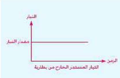
ان التيار الخارج من البطارية الكهربائية هو تيار مستمر وهو ثابت المقدار والاتجاه (يعد مثاليا)
