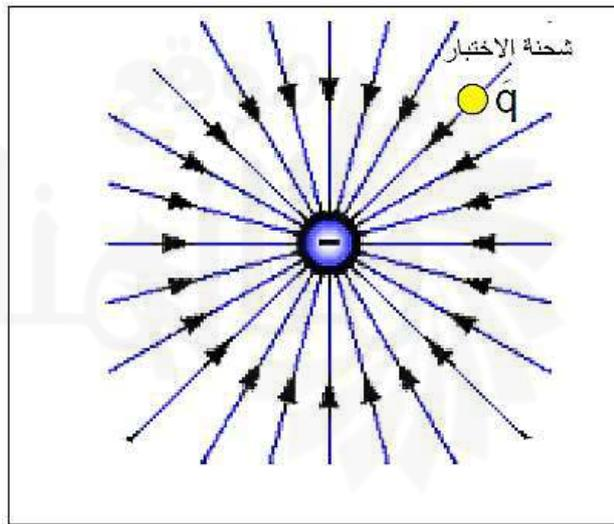
والشكل (25-b) يمثل مجالاً كهربائياً لشحنة كهربائية سالبة ( $-q$ ). وهذا يعني ان المجال الكهربائي عند نقطة ما، يعرف بدلالة القوة الكهربائية المؤثرة في شحنة الاختبار الموضوعة في تلك النقطة.
