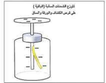
❖ الكشاف الكهربائي المشحون بطريقة التماس تنفرج ورقته لاكتسابهما شحنة مماثلة لشحنة الجسم الملامس
