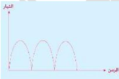
ان التيار الخارج من المولد الكهربائي البسيط هو تيار مستمر وهو ثابت الاتجاه ومتغير المقدار (يعد غير مثاليا)
