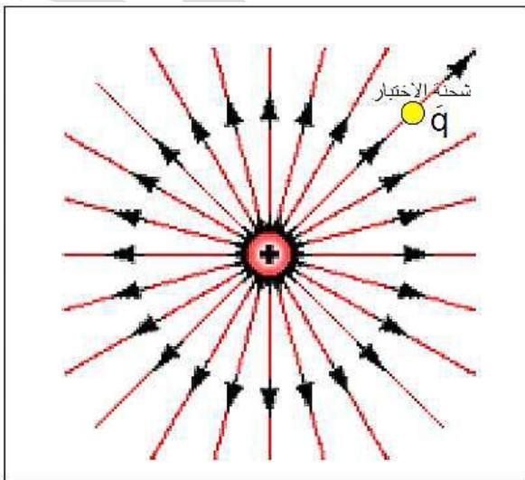
يبين الشكل (25-a) شحنة نقطية موجبة ( $+q$ ) تولد مجالاً كهربائياً، وشحنة ( $q$ ) هي شحنة الاختبار.
