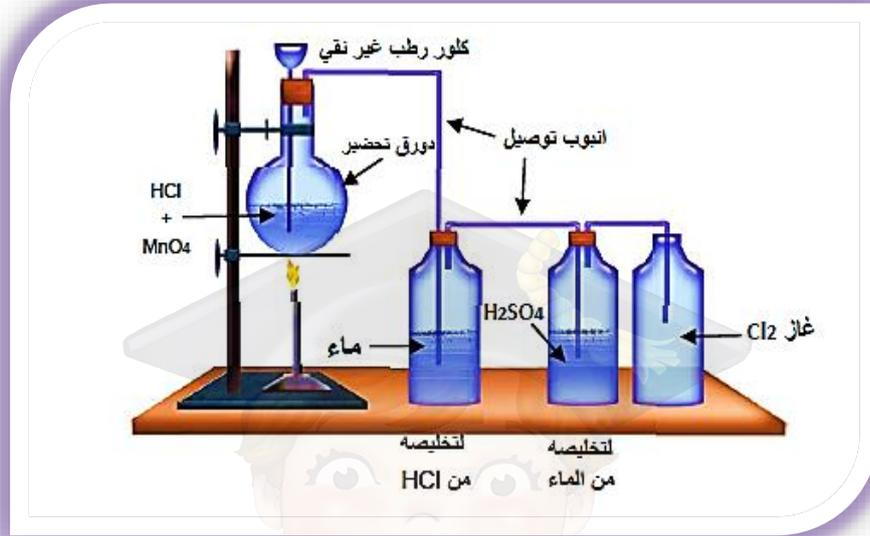
ويخلص غاز الكلور الناتج من غاز كلوريد الهيدروجين HCl والماء (الرطوبة) بإمراره على قناني تحتوي على الماء وحامض الكبريتيك كما في جهاز التحضير ، ويسلك ثنائي اوكسيد المنغنيز  $\text{MnO}_2$  سلوك عامل مؤكسد في عملية تحضير غاز الكلور وليس عامل مساعد لانه يستهلك فيها .
